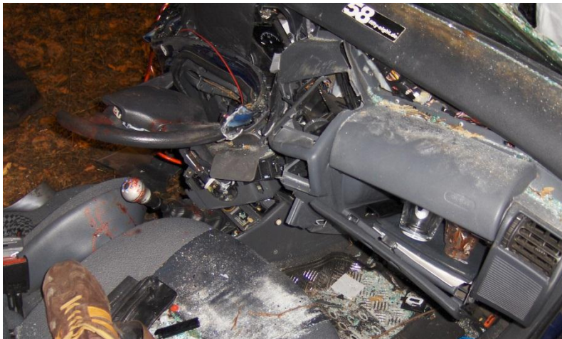
Beispiel: Seitenaufprall gegen Baum; Fahrer- und Beifahrerairbag (bestimmungsgemäß) nicht ausgelöst
